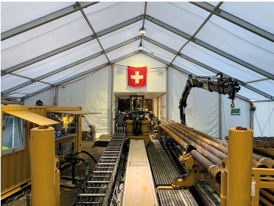
Fertig installierte Bohranlage PD 250/120 RP in beheizbarem Zelt.
